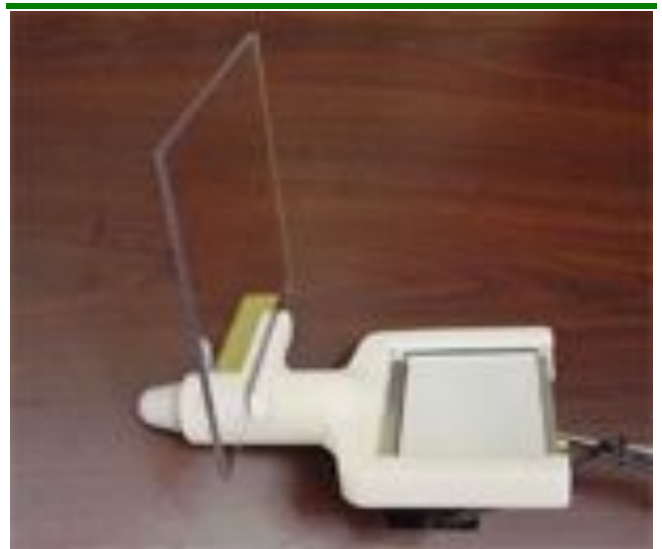
Figura 19: o Sonic Flashlight é um exemplo de equipamento com um display ao alcance da mão que integra o real com o virtual por meio ótico.
