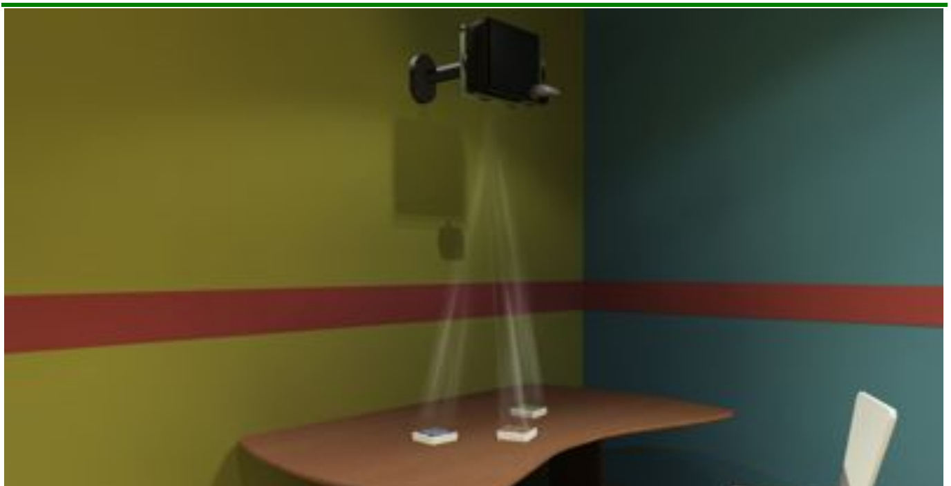
Figura 38: de acordo com o seu conceito, o ARBlocks faz uso das vantagens da realidade aumentada projetiva para adaptar os tradicionais jogos de blocos.
