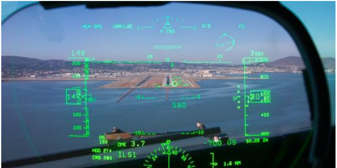
Figura 4: os head-up displays , já encontrados em muitos aviões nos dias de hoje, são um bom exemplo para ilustrar a utilização da realidade aumentada projetiva. As informações virtuais são inseridas diretamente no mundo real através de projetores.
