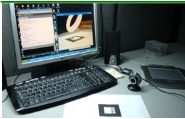
Figura 20: monitor de computador sendo usado como display baseado em tela.
