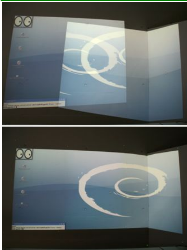
Figura 29: alinhamento de projetores em sistema com mais de um deles. Em cima, antes do alinhamento e embaixo após esta etapa.
