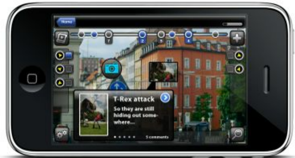
Figura 18: celular com uma aplicação de realidade aumentada utilizando informação da câmera e dos sensores do aparelho.
