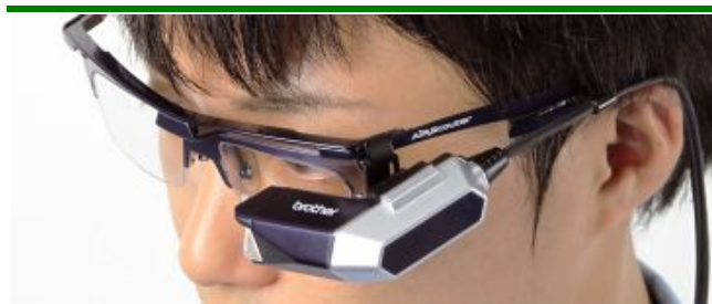
Figura 16: exemplo, acoplado a um óculos, de um display de retina que projeta a informação diretamente nos olhos do usuário.
