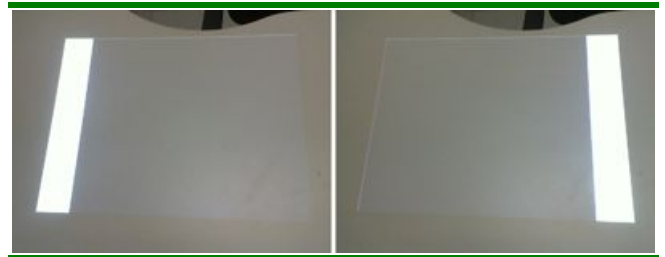
Figura 48: luzes estruturadas emitidas em sequência para que o alinhamento seja realizado.
