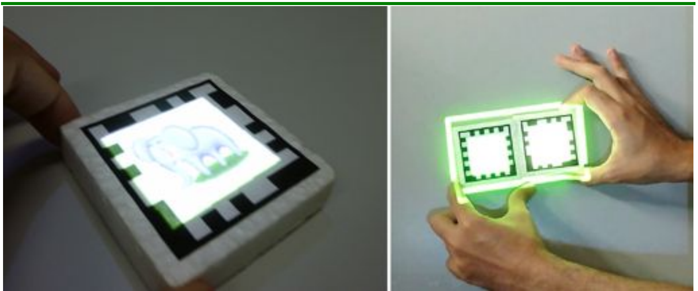
Figura 52: a esquerda é possível ver um bloco contendo uma informação projetada dentro da área vazia. Já na foto da direita o sistema está dando um retorno positivo para o usuário por ele ter juntado corretamente dois blocos correspondentes.
