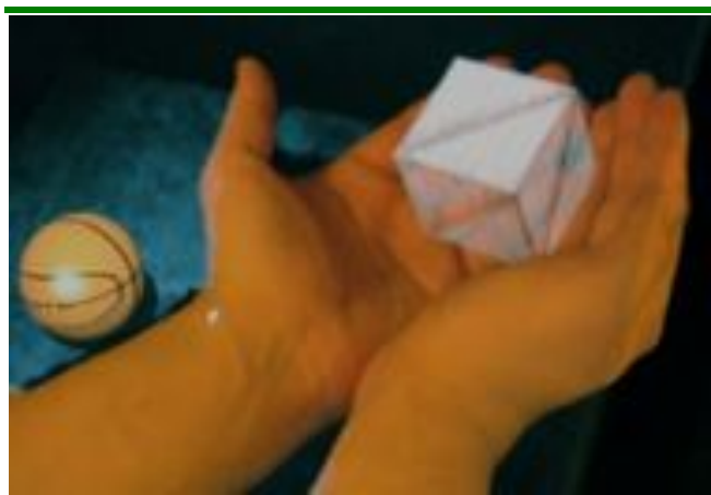
Figura 21: o HoloDesk, da Microsoft, é um exemplo de display espacial ótico que usa uma tela transparente para criar a sensação de hologramas.
