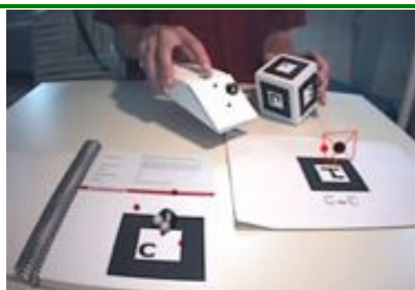
Figura 33: Augmented Chemistry em uso. Nele pode ser vista a garra na mão direita do usuário e o cubo que indica a orientação na mão esquerda. No canto inferior esquerdo da imagem está o catálogo de elementos e no inferior direito da figura, vemos a molécula montada pelo aluno.
