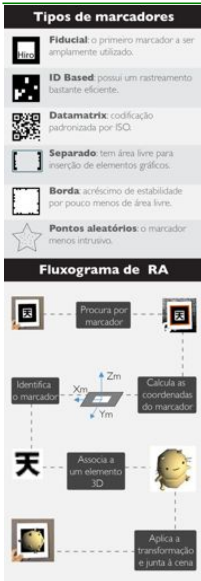
Figura 12: no topo do infográfico, a sequência básica de passos para o rastreamento de marcadores; abaixo, uma comparação entre seus vários tipos.
