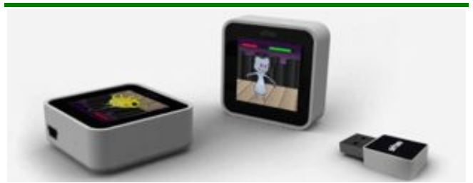
Figura 39: dois Sifteos juntamente com um dispositivo para conectá-los ao computador.
