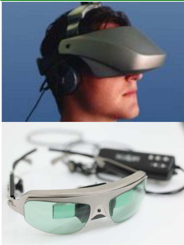
Figura 17: em cima, um exemplo de um HMD video see-through , enquanto embaixo, um HMD optical see-through é mostrado.
